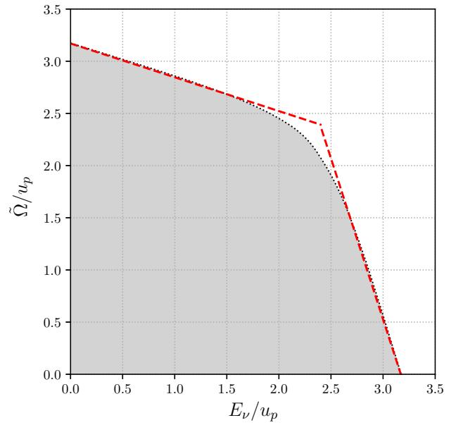
**Рис. 2.** Область существования решений системы первых уравнений (65). Темно-серым цветом обозначена область параметров, полученная в результате численного решения, красная штриховая линия — линейный закон (67)
