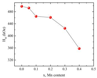
**Рис. 5.** Концентрационная зависимость среднего значения сверхтонкого поля на ядрах железа в  ${
