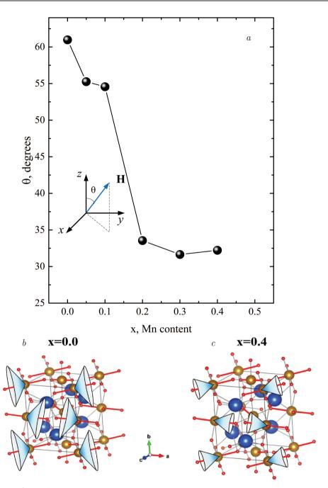
**Рис. 12.** (В цвете онлайн) a — Зависимость изменения угла взаимного расположения векторов главной компоненты ГЭП и сверхтонкого поля на ядрах железа.  $b,\ c$  — Схематичное расположение векторов сверхтонкого поля (по поверхности конуса) и вектора  ${\bf V}_{zz}$  (красные жирные линии) для двух концентраций
