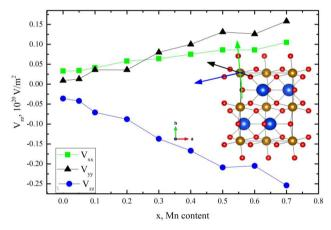
Рис. 3. (В цвете онлайн) Значение компонент тензора ГЭП в зависимости от концентрации  ${\rm Mn}$  в  ${\rm HoFe_{1-x}Mn_xO_3}.$  На вставке показаны направления всех компонент вектора ГЭП относительно кристаллографических осей
