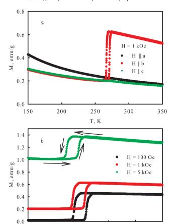
**Рис. 9.** (В цвете онлайн) a — Температурные зависимости намагниченности M(T) для монокристалла  ${
