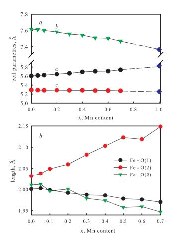
**Рис. 2.** (В цвете онлайн) a — Изменение параметров ячейки a,b,c в  $\mathrm{HoFe_{1-x}Mn_xO_3}$  в зависимости от концентрации марганца. Синие ромбы — значения параметров ячейки для кристалла  $\mathrm{HoMnO_3}$  из работы [38]. b — Концентрационная зависимость длин связей  $\mathrm{Fe-O(1)}$  и  $\mathrm{Fe-O(2)}$  в железо-кислородном октаэдре в зависимости от содержания марганца
