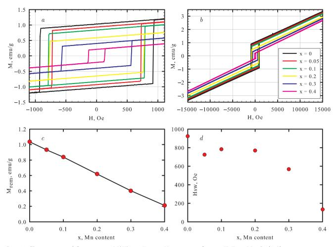
**Рис. 11.** (В цвете онлайн) Зависимости M(H) при  $T=300\,\mathrm{K}$  для серии образцов  $\mathrm{HoFe_{1-x}Mn_xO_3}$  (a,b), а также значения величины остаточной намагниченности при H=0 (c) и поля переключения (d) в зависимости от содержания марганца
