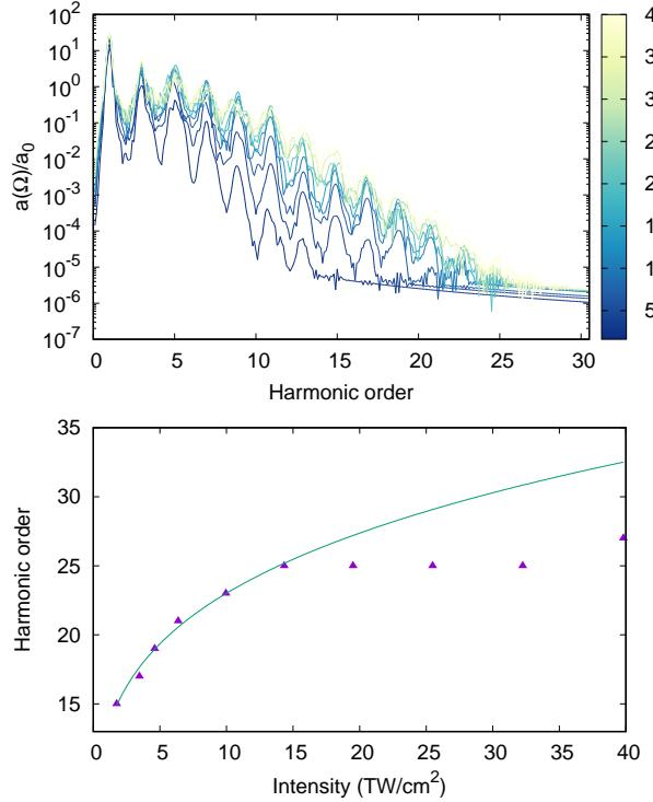
**Рис. 5.** (В цвете онлайн) Верхняя панель — зависимости спектров ГВГ от номера гармоники для  $C_{180}$  в логарифмическом масштабе через преобразование Фурье дипольного ускорения,  $a(\Omega)/a_0$ . Частота волны накачки равна  $\omega = 1.5 \text{ эВ}/\hbar$  (длина волны 827 нм), интенсивность волны  $10 \text{ ТВт}/\text{см}^2$ . Нижняя панель — зависимость гармоник отсечки от интенсивности волны вместе с аппроксимационной функцией (сплошная линия)
