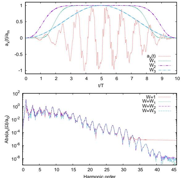
**Рис. 7.** (В цвете онлайн) На верхней панели изображена зависимость  $x$ -компоненты дипольного ускорения от времени вместе с оконными функциями. Интенсивность волны  $10 \text{ ТВт}/\text{см}^2$ , частота 1 эВ (длина волны 1240 нм). На нижней панели показан спектр ГВГ, рассчитанный с использованием оконных функций, соответствующих дипольному ускорению на верхней панели
