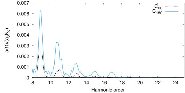
**Рис. 6.** Сравнение сигналов ГВГ, нормированных на число частиц, для  $C_{180}$  и  $C_{60}$ . Частота волны накачки равна  $\omega = 1.5 \text{ эВ}/\hbar$  (длина волны 827 нм), интенсивность волны  $10 \text{ ТВт}/\text{см}^2$
