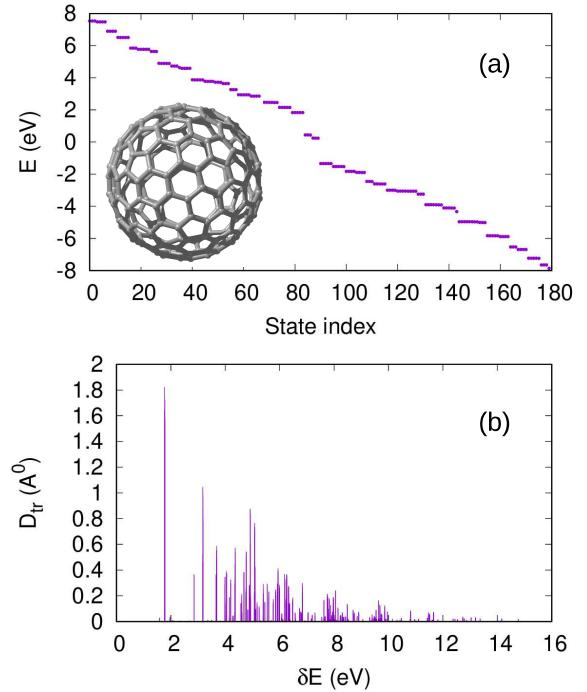
**Рис. 1.** *a* — Собственные энергии молекулы фуллерена  $C_{180}$  и *b* — модуль матричных элементов дипольного момента при межзонных переходах. На вставке приведена схематическая структура  $C_{180}$
