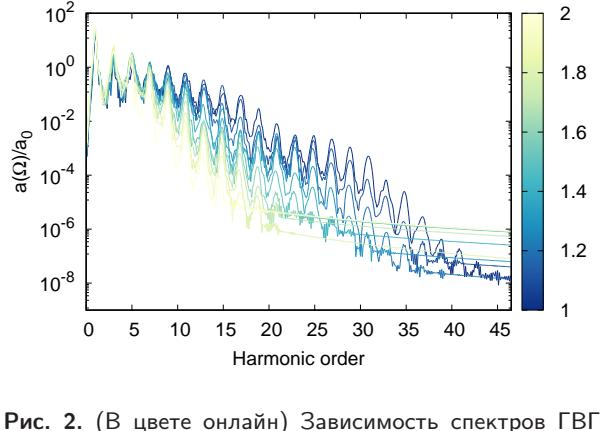
**Рис. 2.** (В цвете онлайн) Зависимость спектров ГВГ от номера гармоники представлена для  $C_{180}$  с использованием нормированного преобразования Фурье дипольного ускорения,  $a(\Omega)/a_0$ , построенного в логарифмическом масштабе. Интенсивность волны равна  $10 \text{ ТВт}/\text{см}^2$ . Цветная полоса показывает частоту волны накачки в единицах  $\text{эВ}/\hbar$
