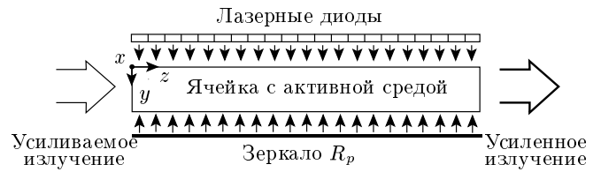
Рис. 2. Схема усилителя лазерного излучения на парах щелочных металлов с поперечной диодной накачкой
