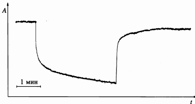
Рис. 8. Временная зависимость амплитуды стимулированного эха при выключении и включении пары записывающих радиочастотных импульсов (эффект накопления)
