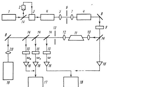
FIG. 1. Schematic diagram of the apparatus: 1) ruby laser; 2) spark gap with laser ignition; 3) electro-optic switch; 4) ruby amplifier system; 5), 7), 10), 12), 20) lenses; 6) stop; 8) mirrors; 9) neutral optical filters; 11) cell with hydrogen; 13) stop; 14) glass plate; 15) optical filters; 16) coaxial photocells; 17), 18) oscilloscopes; 19) DFS-8 spectrograph.
