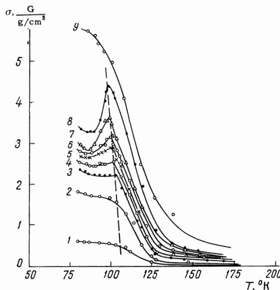
FIG. 1. Temperature dependence of the specific magnetization of  $U_3Te_4$  at different fields: curve 1—500 Oe, 2—1000 Oe, 3—2000 Oe, 4—3000 Oe, 5—4000 Oe, 6—5000 Oe, 7—5900 Oe, 8—7000 Oe, 9—14,000 Oe.
