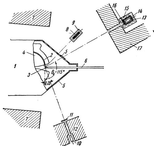
FIG. 1. Experimental arrangement. 1) Cyclotron chamber, 2) ion beam, 3) target, 4) dee, 5) diaphragm, 6) probe, 7) magnet, 8)  $\text{BF}_3$  counter, 9) paraffin, 10) neutron counter, 11) Pb shield for  $\gamma$  quanta (0.02 m), 12) concrete, 13) scintillation  $\gamma$  spectrometer, 14) lead (0.05 m), 15)  $\text{H}_2\text{O} + \text{B}$  (0.2 m) shield, 16) Pb diaphragm (0.05 m), 17) concrete shield (1.0 m)
